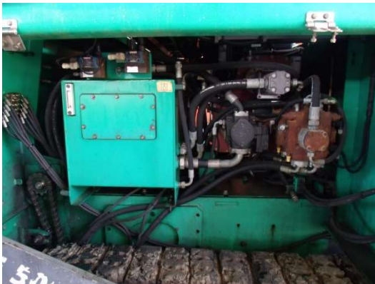
Figuras 10/11 - A capacidade do reservatório influi na vida útil dos componentes do sistema hidráulico
