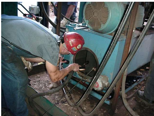
Figuras 13/14 - Limpeza ocasional e drenagem do reservatório
