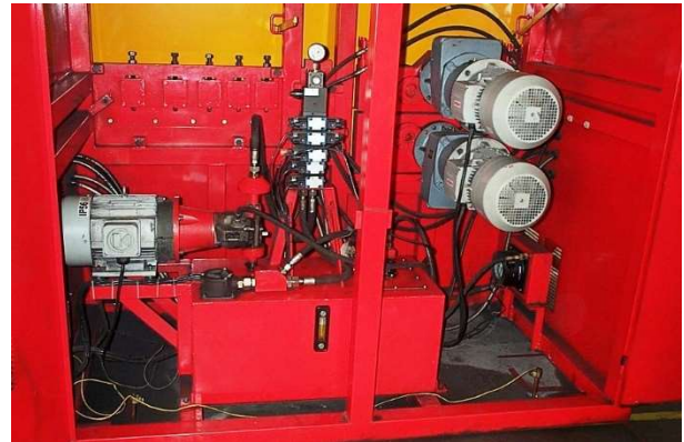
Figuras 10/11 - A capacidade do reservatório influi na vida útil dos componentes do sistema hidráulico
